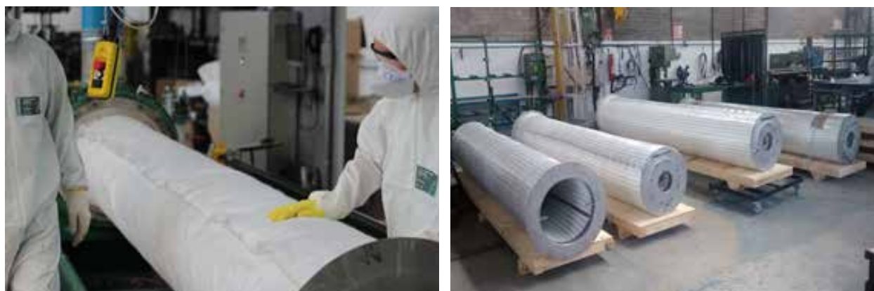
Figura 2: Eliminador de Névoas Clark Solutions - Fiberbed®, fabricação e modelo Dual Bed®
