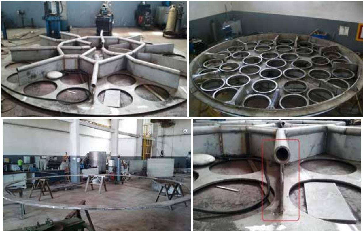
Figura 8 - Projeto e fabricação do novo espelho
