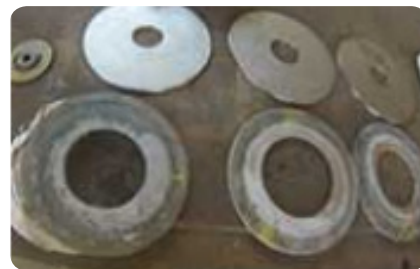
Figura 8 | Velho (baixo) e o novo (cima) orifícios do prato.
